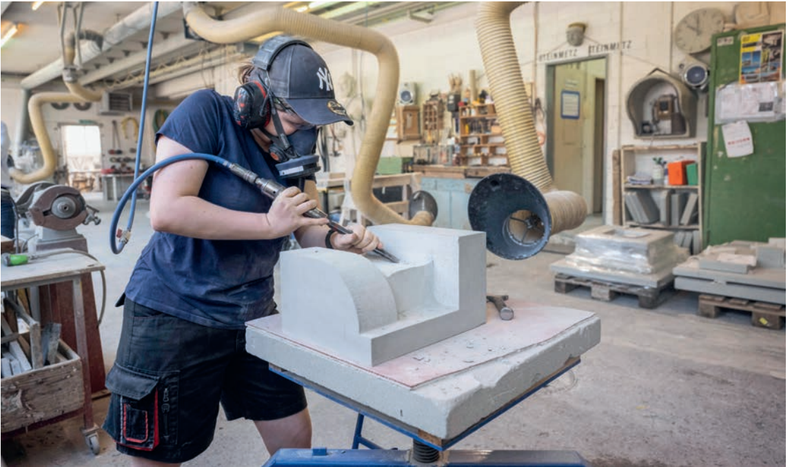
Konzentriert bearbeitet Noëlle Egger den Sandstein mit einem Meissel mit Druckluftimpulsen. Lernende üben zuerst die manuelle Bearbeitung mit einem Hammer, bevor sie eine Druckluftpistole erhalten. Schutzbrille und Atemschutz sind bei der staubigen Arbeit selbstverständlich.
