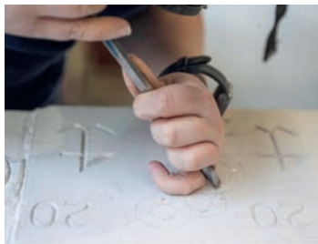
Noëlle Egger hat von Hand einen Plan des Prüfungsstücks gezeichnet. Gravuren sind an den SwissSkills eine Prüfungsdisziplin für Steinmetze. Bevor Noëlle Egger den Stein bearbeitet, bringt sie die Abluftvorrichtung in Position.
