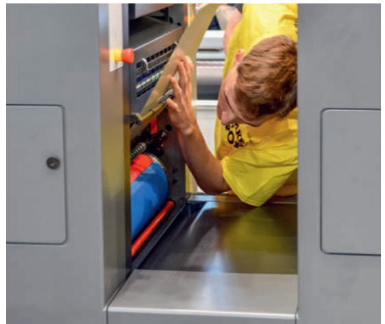
Sorgfältig legt Livio Furer eine Druckplatte in ein Druckwerk ein.
