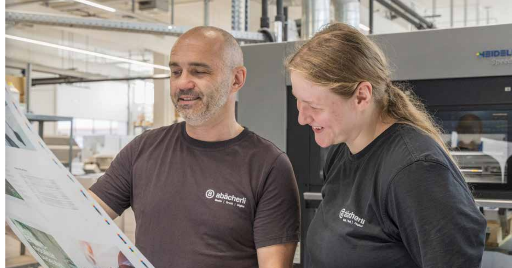
Ivan Bedin (links) und Cheyenne Luternauer begutachten das Druckbild eines Auszugs: Es braucht gegen 150 Bögen, bis die Farben und der Passer richtig sind.
