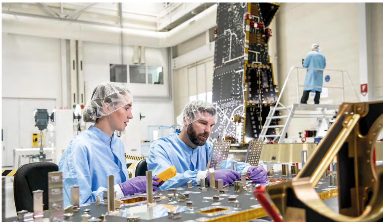
La Suisse contribue par le biais de technologies clés à ce que les infrastructures européennes soient compétitives au niveau mondial. Intégration d'une structure de satellite pour Metop Second Generation dans l'industrie suisse. Photo : Beyond Gravity
