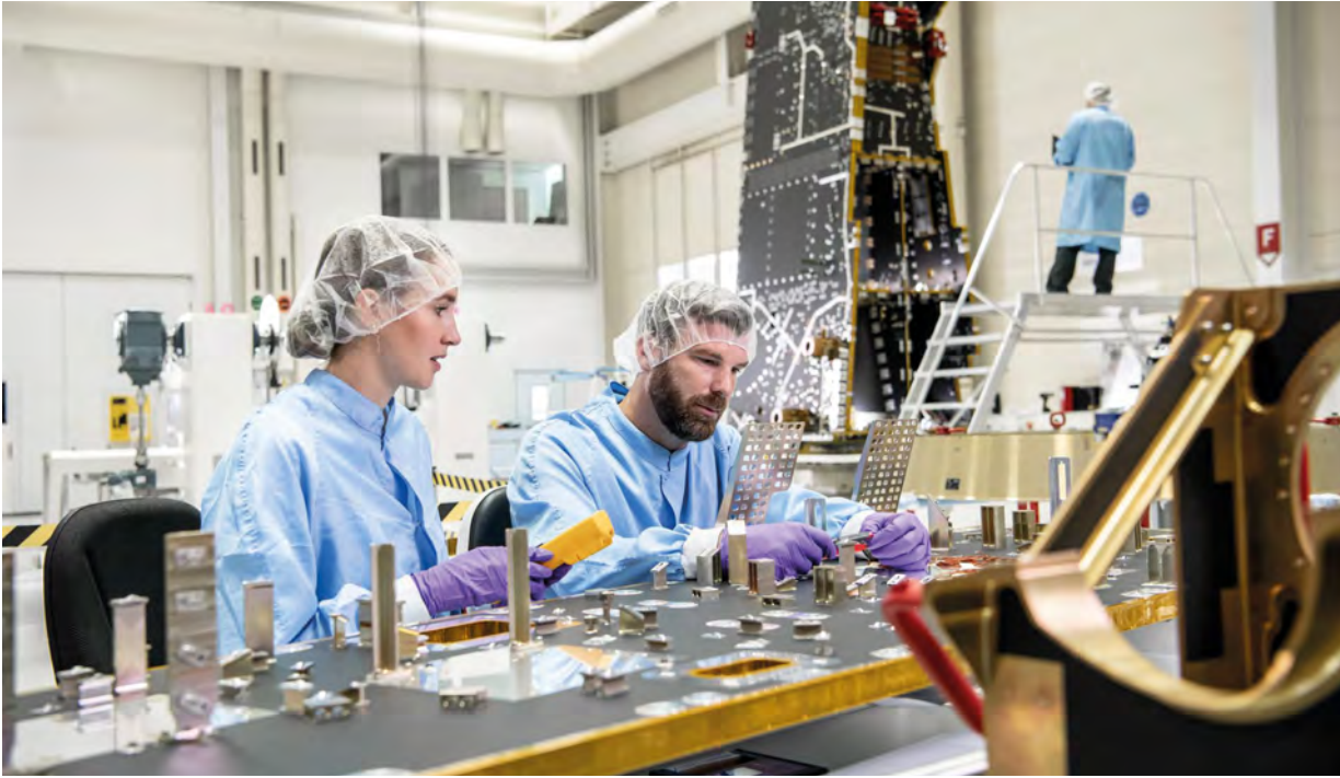
Die Schweiz trägt mit Schlüsseltechnologien dazu bei, dass europäische Infrastrukturen global wettbewerbsfähig sind. Integration einer Satellitenstruktur für Metop Second Generation in der Schweizer Industrie. Bild: Beyond Gravity
