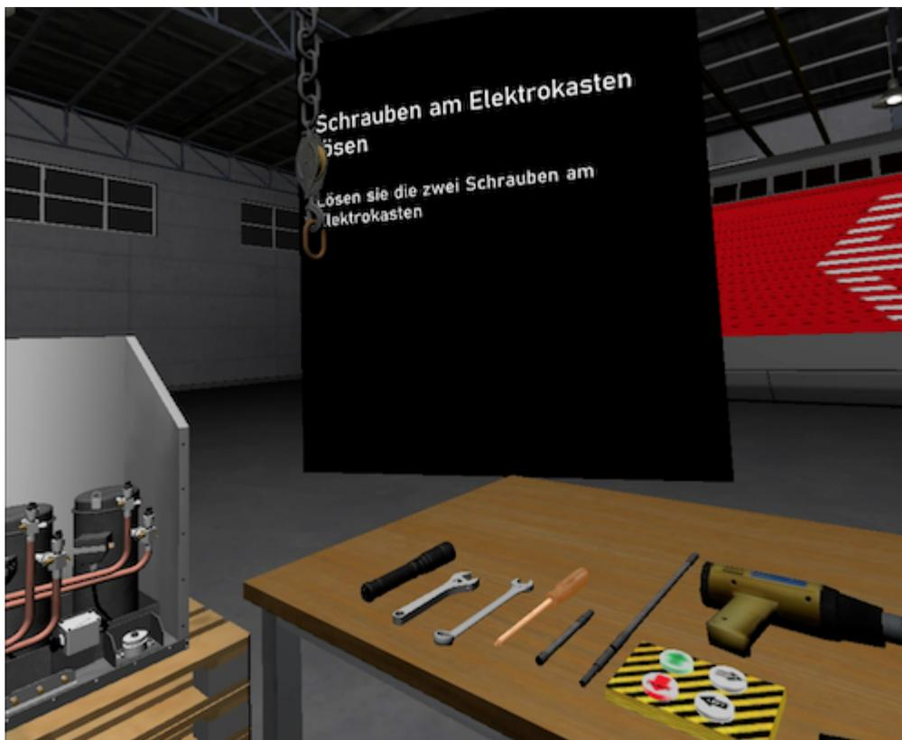
Abbildung 1: Virtuelle Werkstatt und Aufgabe des Verdichterwechsels. Die zu benutzenden Objekte blinken orange und leiten somit den Auszubildenden an. Eine Tafel gibt detaillierte Instruktion.
