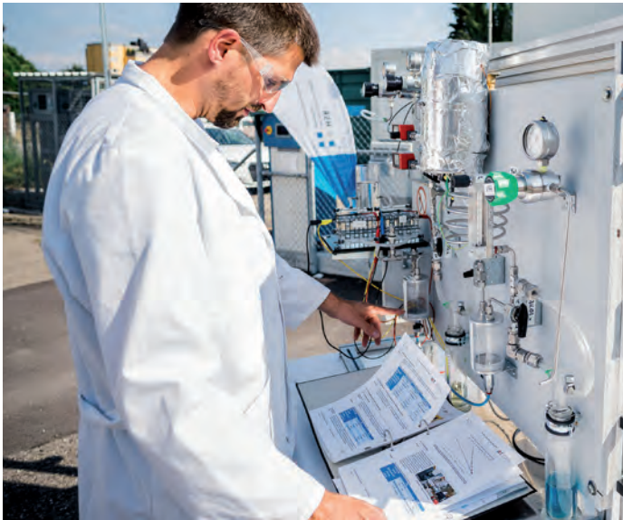
HSR Forscher Christoph Steiner führt einen Test an der Mini-Power-to-Gas-Anlage durch. Im Hintergrund ist die grosse Power-to-Gas-Forschungsanlage zu sehen.
