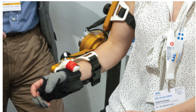
Greifbare Innovationstätigkeit: Auf der Messe konnten zahlreiche Prototypen selbst getestet werden, wie etwa dieser eigenkraftverstärkende Handschuh des AAL Projekts «ironHand», an dem von Schweizer Seite die terzStiftung sowie die Hocoma AG beteiligt sind.
