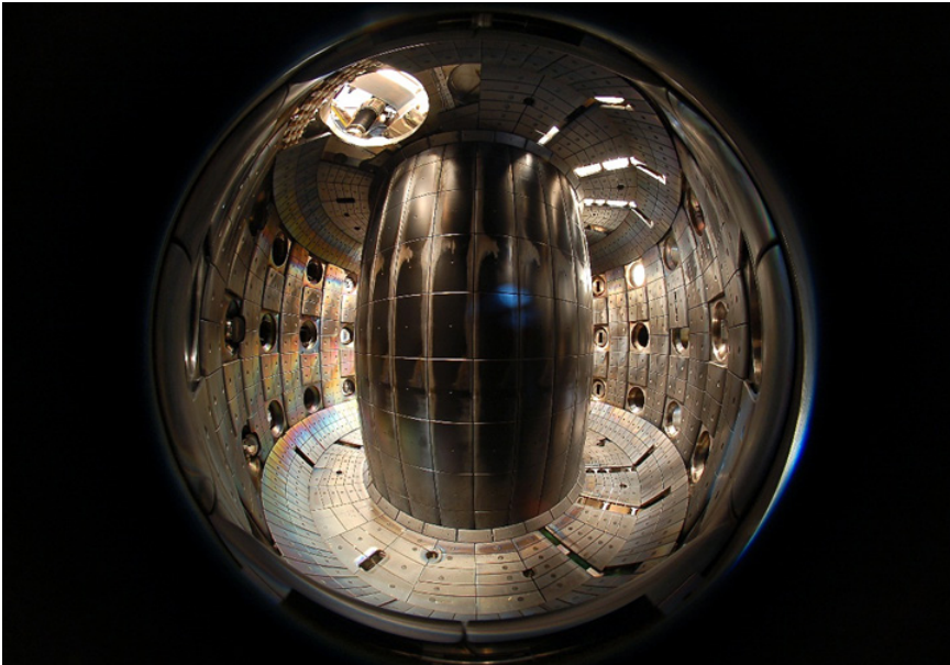
Herzstück des Swiss Plasma Centers ist der Tokamak; ein Fusionsreaktor, in welchem ein heisses Plasma aus Wasserstoff oder seiner Isotope durch ein Magnetfeld in Form gehalten wird, ohne dass das Plasma die Reaktorwände berührt, um Abkühlung und Materialschäden zu verhindern. Ab einer bestimmten Temperatur und Teilchendichte tritt eine kontrollierte Kernfusion auf. Ziel ist es, über diesen Weg saubere Energie zu gewinnen. Bild: Alain Herzog, EPFL
