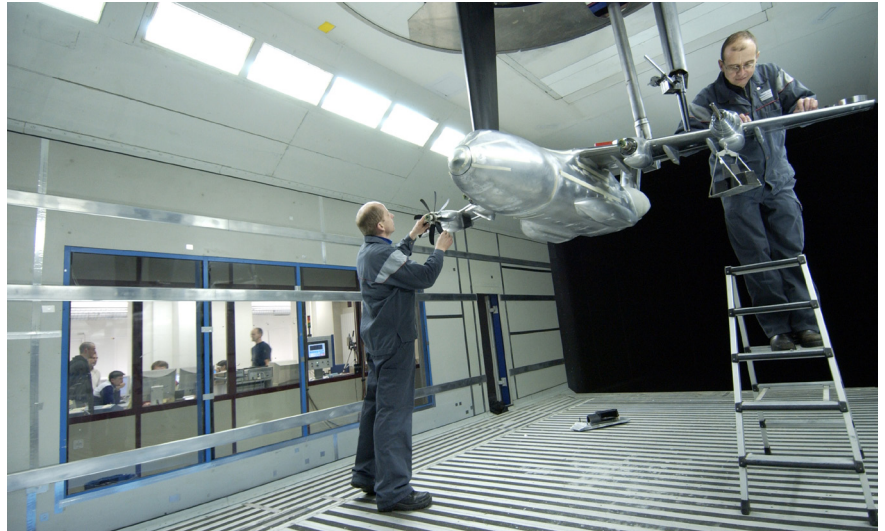
Bei Clean Sky forscht auch die Schweizer Ruag Aviation mit. Das Unternehmen entwickelt u.a. aerodynamische Konzepte für Rumpfhinterende von Flugzeugen. Bild: Ruag Aviation
