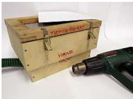
Mit dem Tiefziehapparat wird die Negativform zur Reproduktion hergestellt. Foto: zVg.
