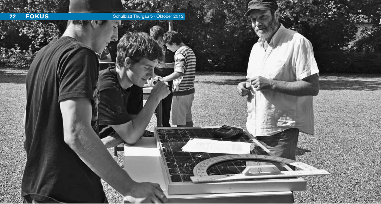
Praktische Messung während der naturwissenschaftlich-technischen Woche 2011: Wie beeinflusst der Sonneneinfallswinkel die Leistung einer Photovoltaikanlage?
