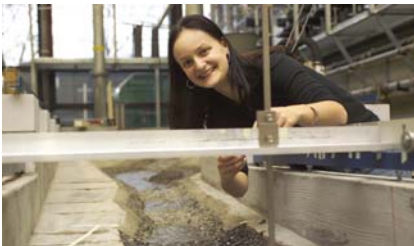
Wasserbau-Labor: Untersuchung an einem hydraulischen Modell für eine Wildbach- Renaturierung (Foto: Susi Lindig)
