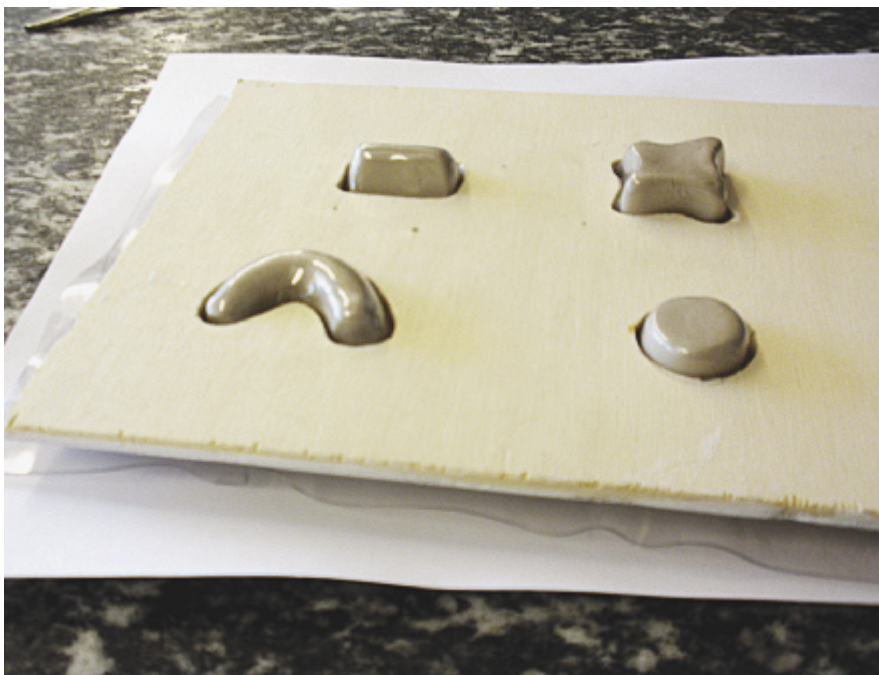
Positiv- und Negativform mit tiefgezogener Folie. Bald darf probiert werden, die Form stimmt. Foto: zVg
