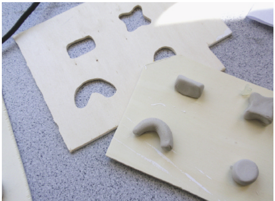
Positiv- und Negativform zum Tiefziehen von Pralinengussformen: Eine süsse Verführung entsteht.
